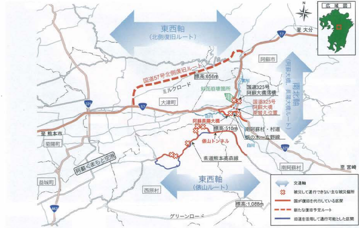
図8 熊本地震における道路の復旧
